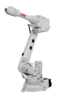
"锋芒一代"机器人第二种型号IRB 2600 携增强创新功能问世。该机型机身紧 凑, 负载能力强, 设计优化, 适合弧焊、 物料搬运、上下料等目标应用。提供三 种子型号,可灵活选择落地、壁挂、支 架、斜置、倒装等安装方式。
