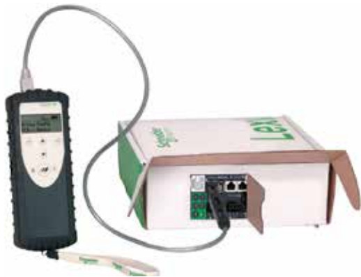
在未拆除Lexium 28包装前, 使用VW3A8121多功能下载器工具+VW3A8126电缆套件对其进行配置
