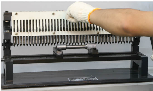
拉伸测试前试棒的压型
