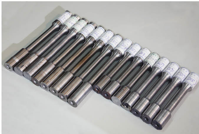
根据ASTM A-370要求精加工过的试棒
