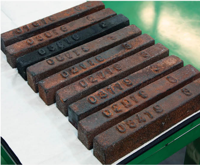
铸件试棒铸有炉号供全程追溯
