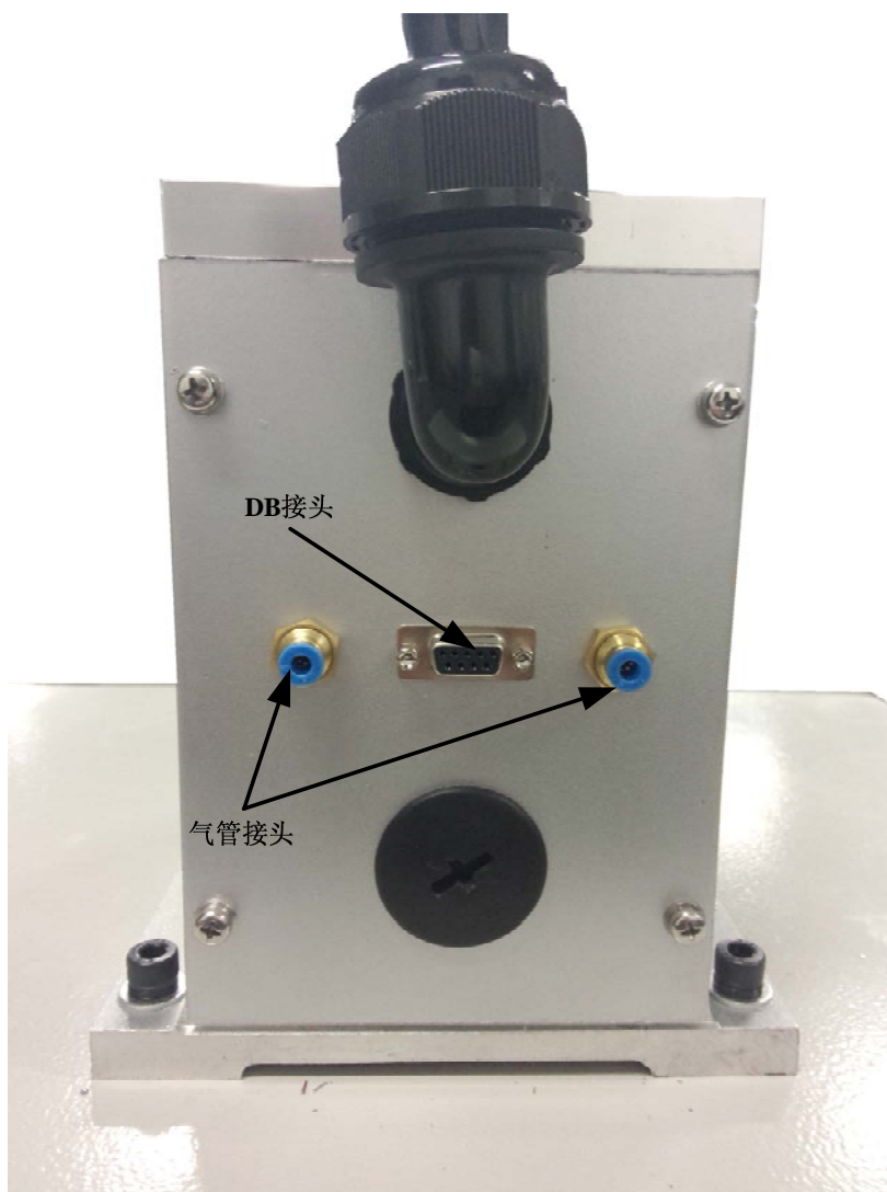
图 2-5 机器人本体的电气布局（续）
