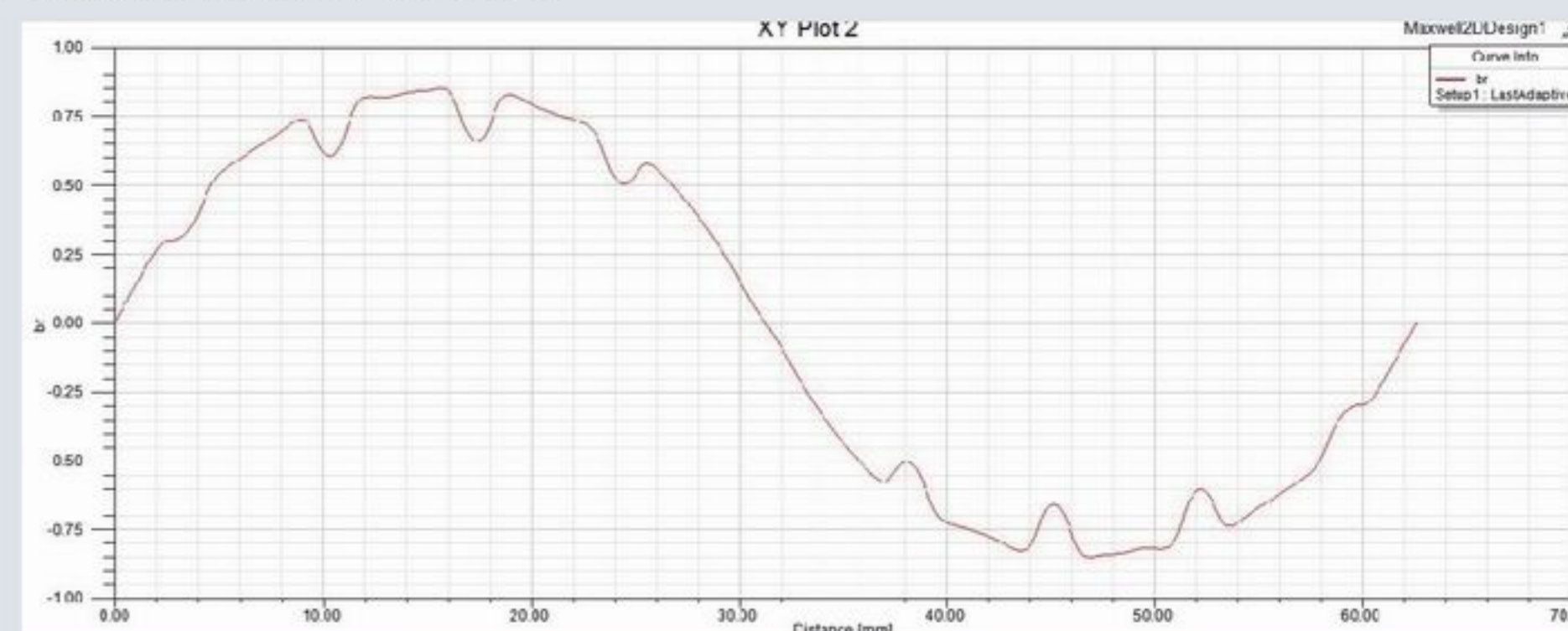
图为我公司伺服电动机磁场波形仿真图，正弦化程度较高
