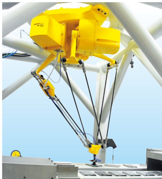
使用 M-2 i A/3SL 进行板金的整齐排列
