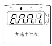
图 4-4 故障告警显示状态
