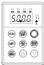
图 b 待机状态, 显示待机状态参数
