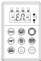
图 a 上电初始化, 显示-EN-
