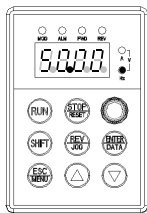
图 c 运行状态, 显示运行状态参数
