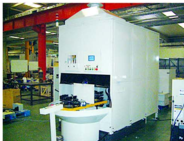
简易回转系统—空调压缩机焊接系统
