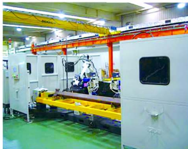
塔吊零部件机器人焊接系统
