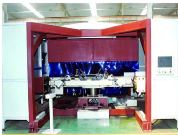
汽车前副车架端管机器人焊接系统
