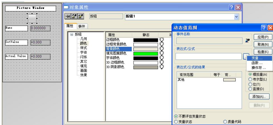
图 5，按钮颜色动态的组态—连接变量
