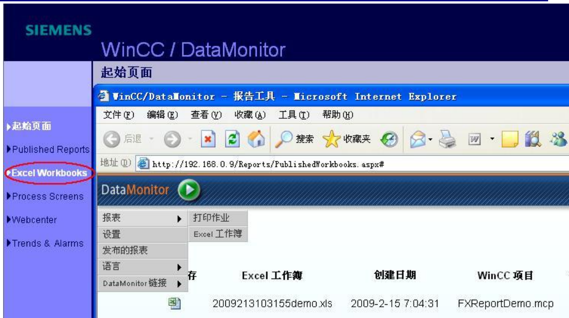
图 11.WinCC/DataMonitor 的操作界面
