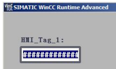
图 3-9 WinCC RT Advanced OPC UA 通信失败
