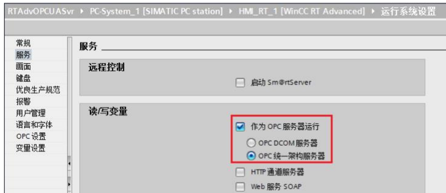
图 2-3 启用 WinCC RT Advanced 项目的 OPC UA 服务器
