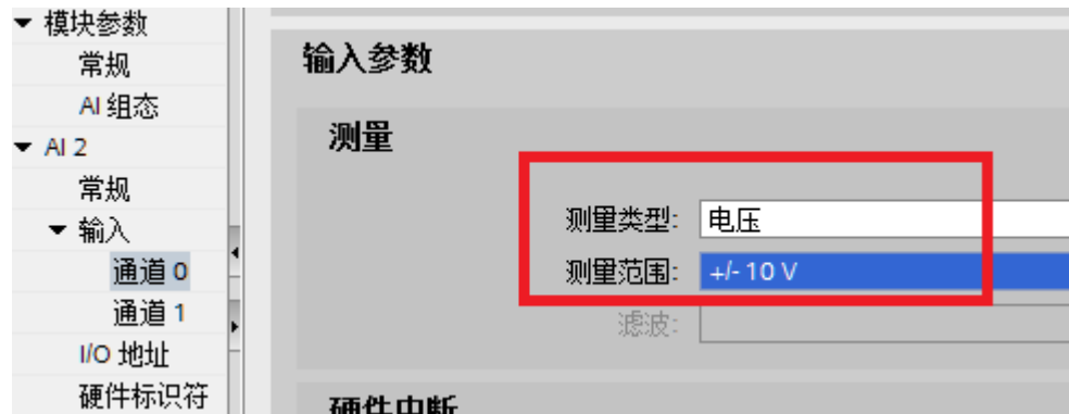
图 2-8 设置 HS AI 模板测量类型
