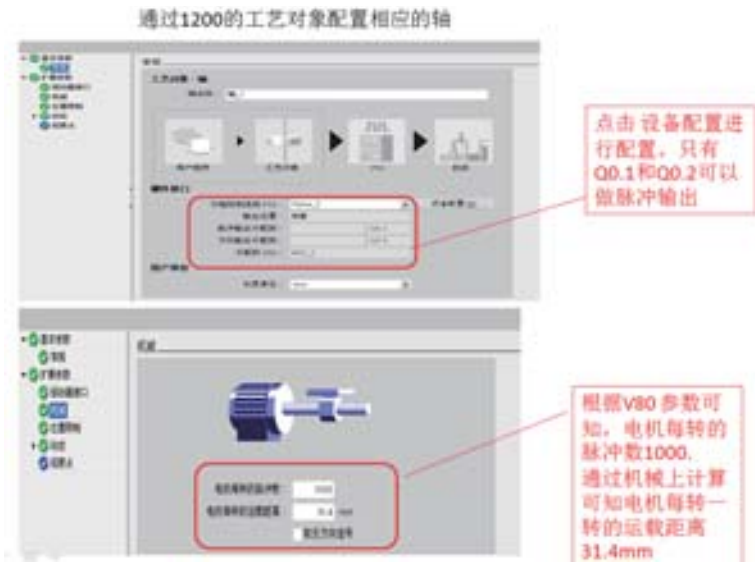
图 6 SIMATIC S7-1200 轴参数配置
