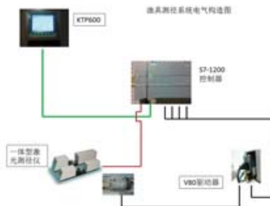
图 1 渔具测径系统电气构造图
