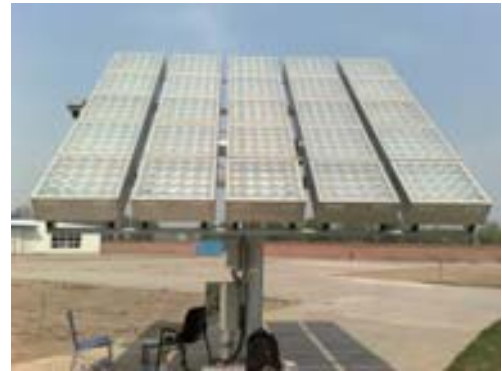
图 1 本项目 CPV 太阳能跟踪控制系统
