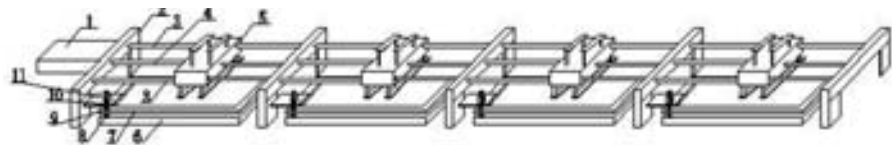
多色连续网版印刷机印刷及定位机构
