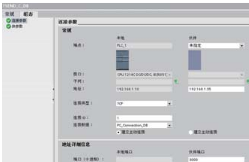
图 5 TSEND_C 功能块连接参数设置
