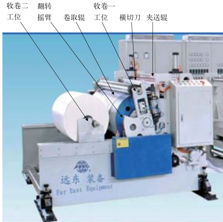
摩擦式卷取机装置示意图
