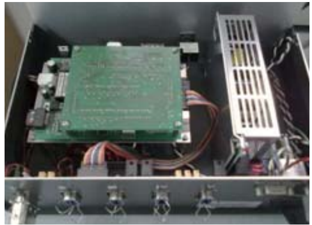
图 6：信号调理 PCB 电路板
