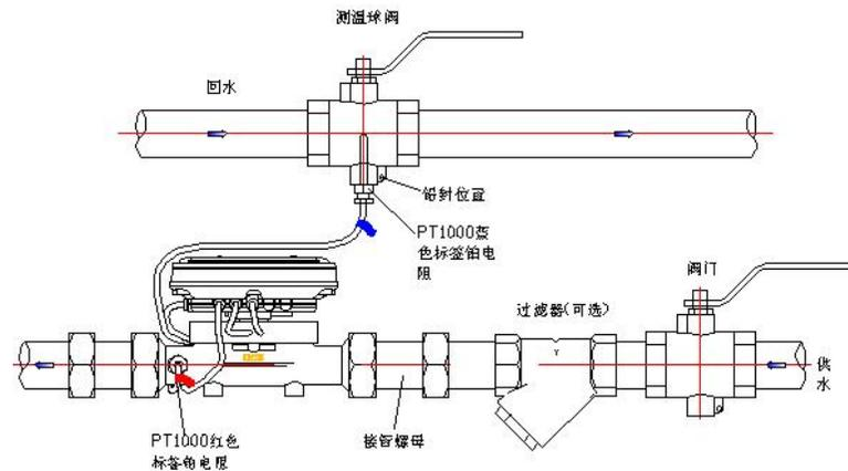
图 3 产品安装示意图
