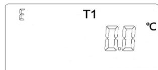
检定显示菜单 E 下的温度 T1 显示状态
