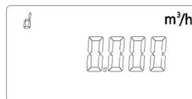
检定显示菜单 D 下的瞬时流量显示状态
