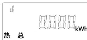
检定显示菜单 D 下的累积热量显示状态
