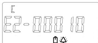
主显示状态下的故障 2 显示状态
