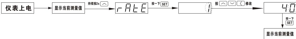
例2：仪表出厂规格为输入DC10V 显示30Hz，如用户需将仪表规格改为输入DC10V 显示500Hz，
