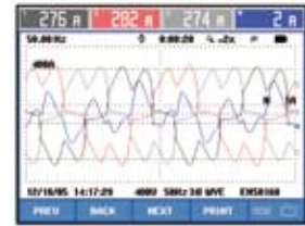
主要谐波源波形图：变频器
