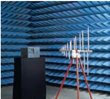
在屏蔽室中进行电磁兼容性测试
