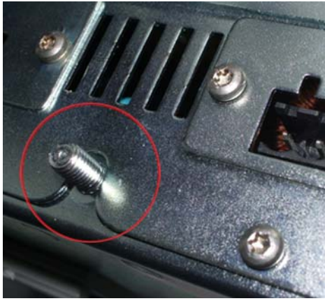
X-300EEC 外壳下侧或 XR-300M-EEC 后部的接地螺栓
