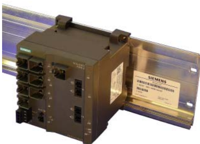
图 5-3 在 SIMATIC S7-300 标准导轨上安装 IE Switch X-300
