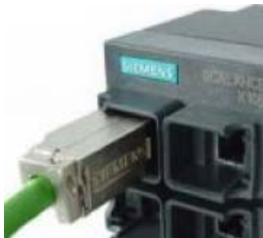
图 A-2 插入 IE FC RJ-45 Plug (以 IE FC RJ-45 Plug 180 为例)
