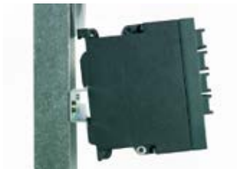
图 4-2 从 35 mm DIN 导轨上拆卸
