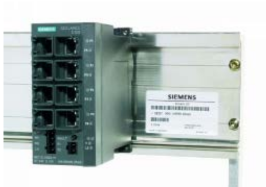
图 4-3 在 SIMATIC S7-300 标准导轨上安装
